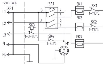
Рис.3 Схема электрическая ТВ 6/12СТ и ТВ 9/12СТ
