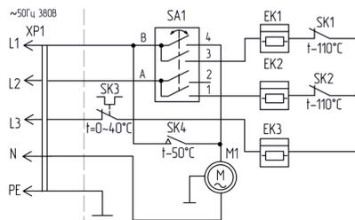
Рис.3 Схема электрическая ТВ 6/12СТ и ТВ 9/12СТ
